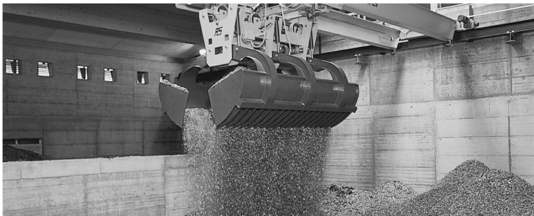
Slika 5.20. Automatski kran za drveni čips, pelete, piljevinu, [1]
