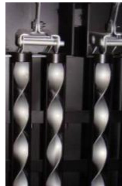
Puževi za automatsko iznošenje pepela i letećeg pepela
