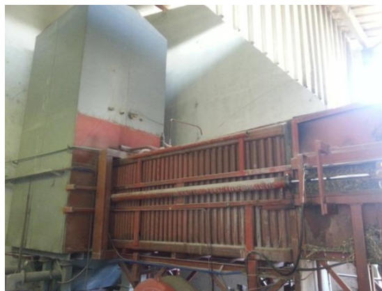
Vodom hlađeni uvodnik bala sa hidrauličnim potiskivačem
