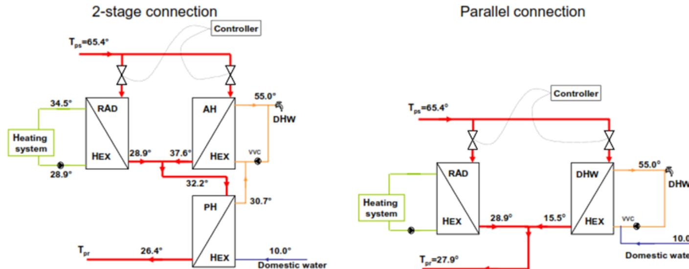
Dvostepena (levo) i paralelno (desno) vezana podstanica (AH-naknadni zagrejač, RAD-radijatori, PH-predgrejač, DHW-sanitarna voda)
